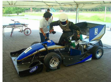
緊急時脱出テスト (5秒以内で脱出可能かを確認)
